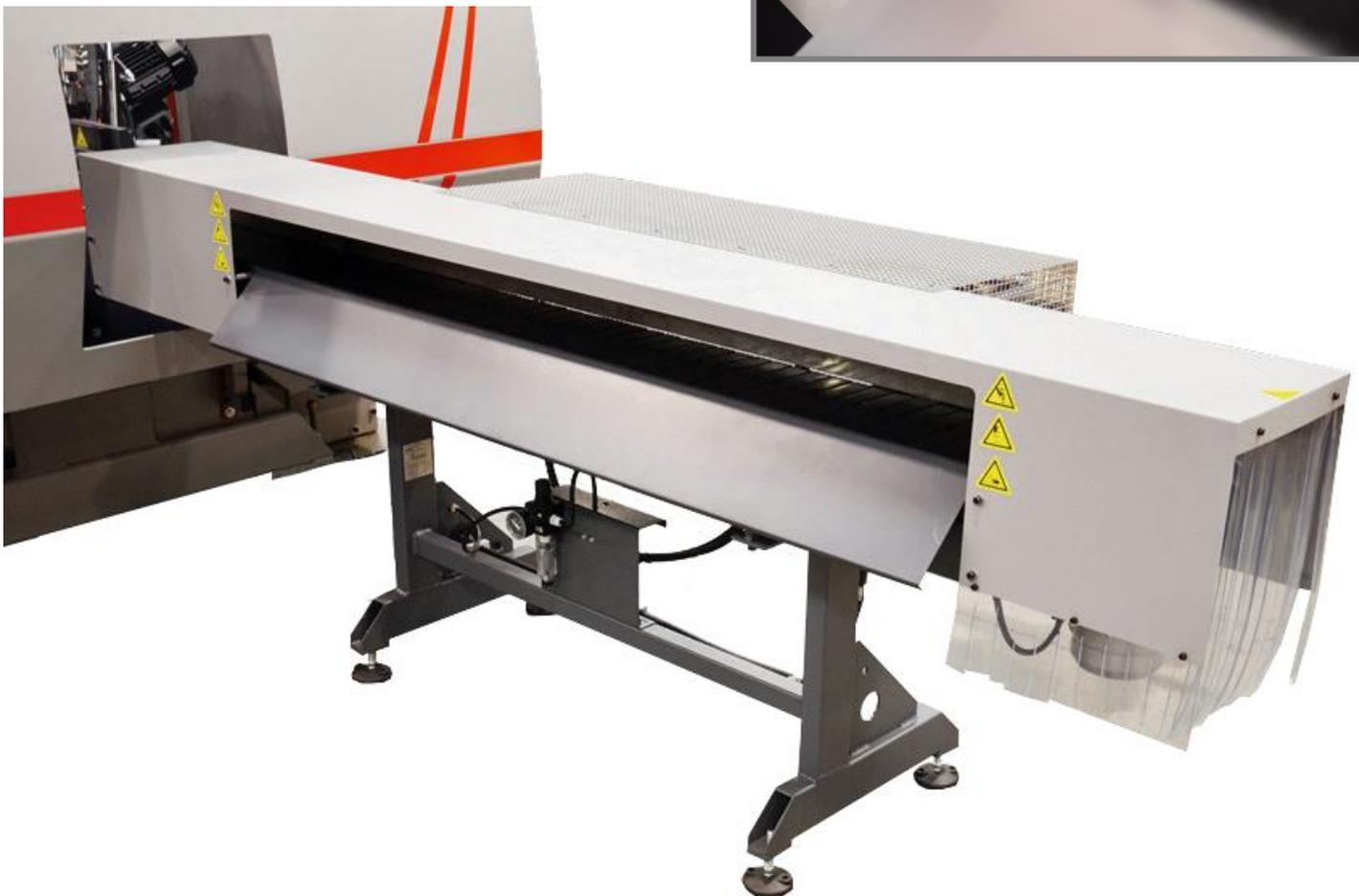
Pour l'évacuation et le tri des pièces sciées en automatique avec une scie à ruban automatique ERGONOMIC 290.250 DGA.
